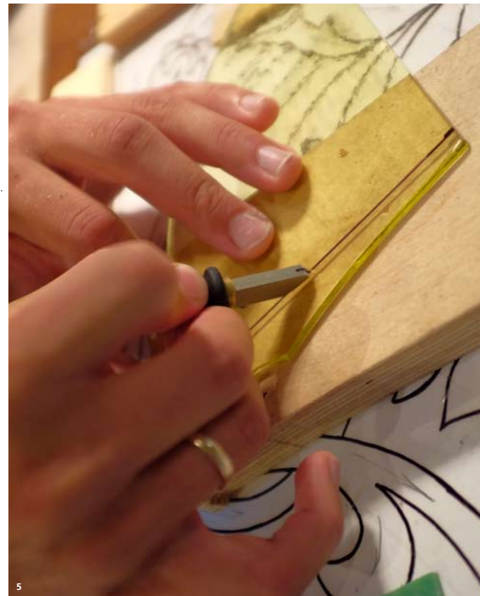
Пример разметки ровного края угловой детали из прозрачного стекла. 1. Наложение заготовки поверх ограничительной рейки. 2–3. Разметка начала и конца прямой линии по краю рейки. 4. Соединение двух пометок по линейке. 5. Обрезка края стеклорезом.
